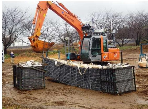
写真 6.2.1-2 遠隔操作による土嚢展開試験
