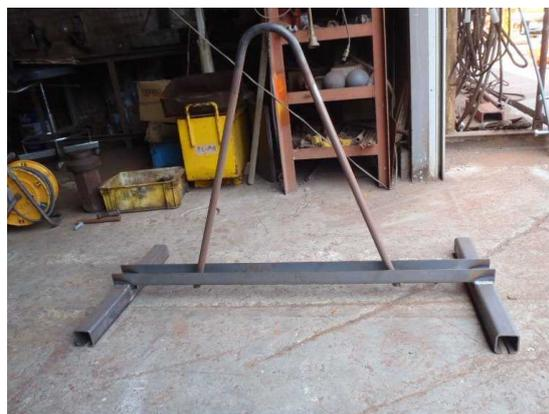
写真 6.3.1-2 土嚢設置治具
