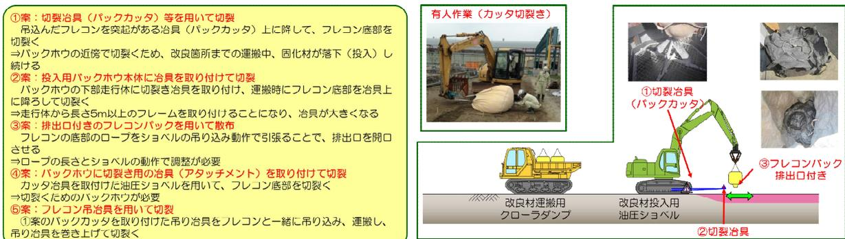
図 6.2.2-5 改良材供給方法の検討と供給例
