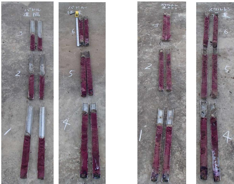
写真 6.3.2-4 中性化試験（攪拌性能）
