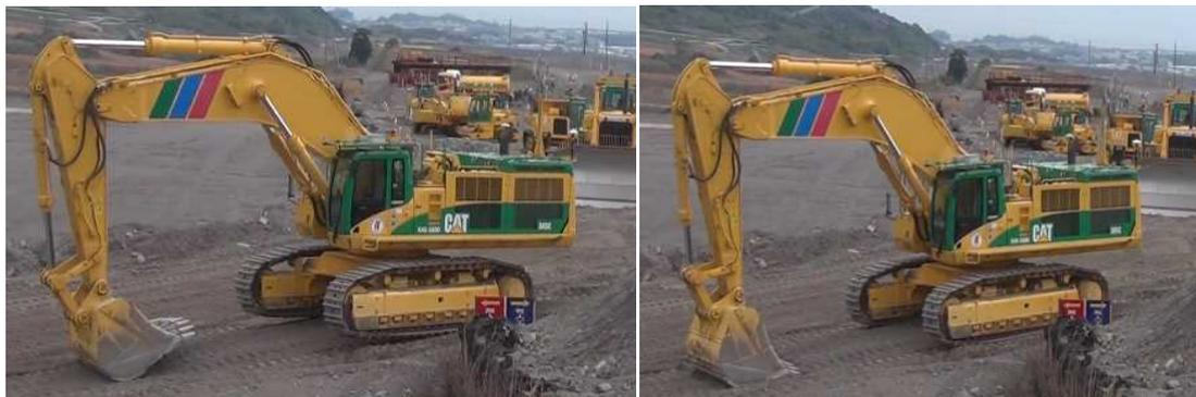
写真 6.3.3-1 3.5m<sup>3</sup>級バックホウ履帯前方の地表面との衝突
