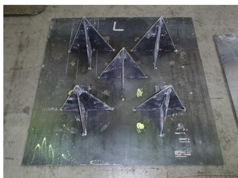
写真 6.3.2-1 切裂き治具 (タイプL)
