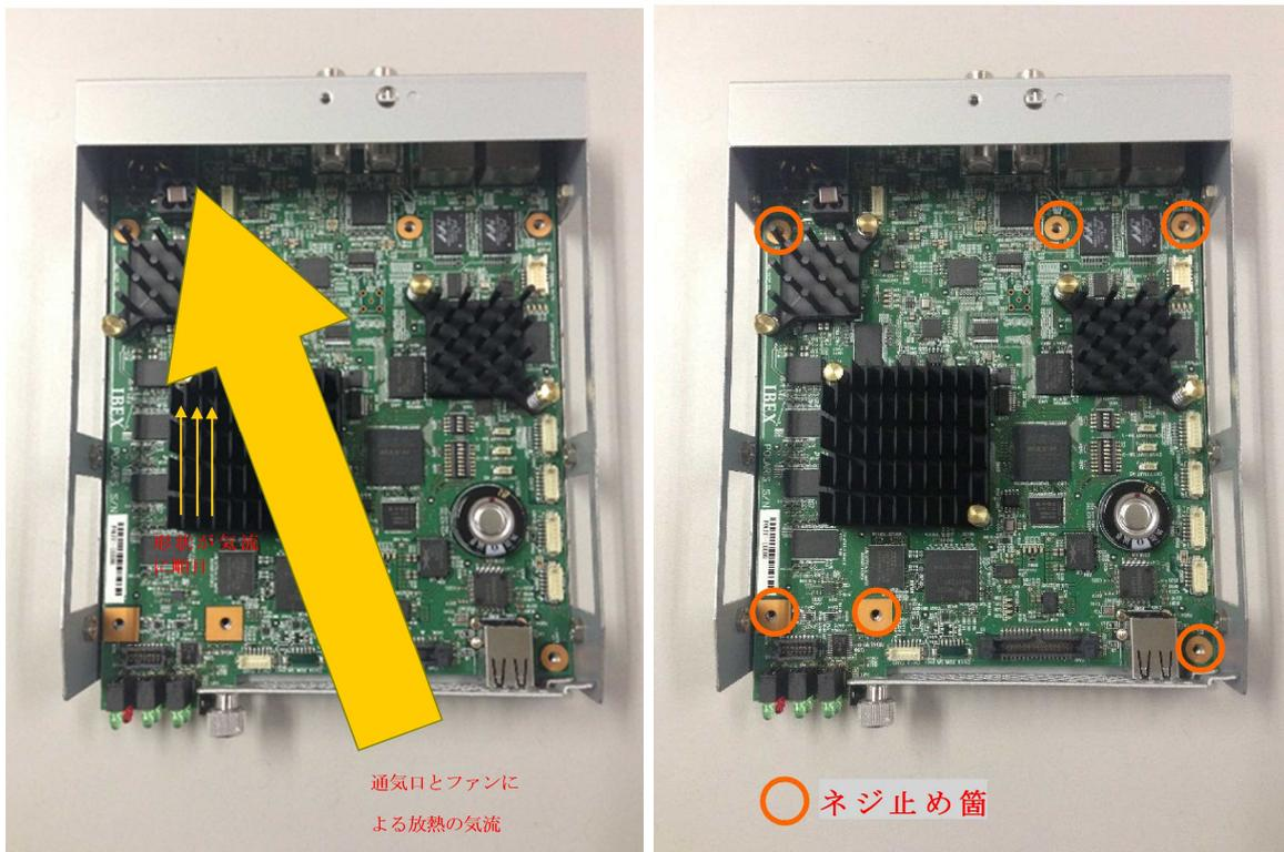
図 6.3.3-3 放熱対策（左）と耐振対策（右）
