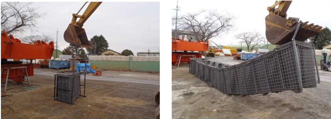
写真 6.2.1-1 新型土嚢および設置ジグの試作と据付試験
