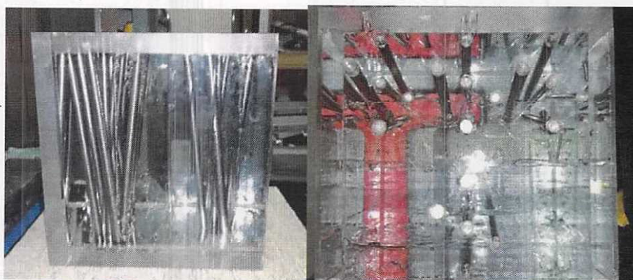
図2. 評価用ファントム (アクリル+鉄筋6~10 mm 径混在)
