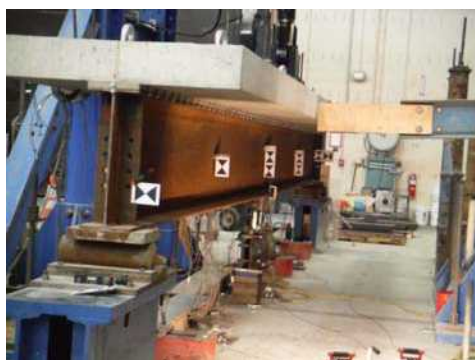
図 2.1 ターゲット設置状況
