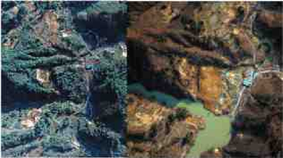
写真 7.1.1-1 東竹沢地区の地すべりによる河道閉塞（アジア航測撮影）
