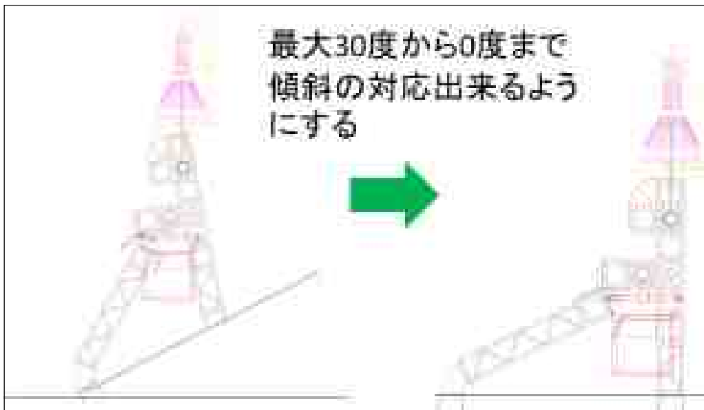
図 7.3.2-4 傾斜 30 度対応のイメージ
