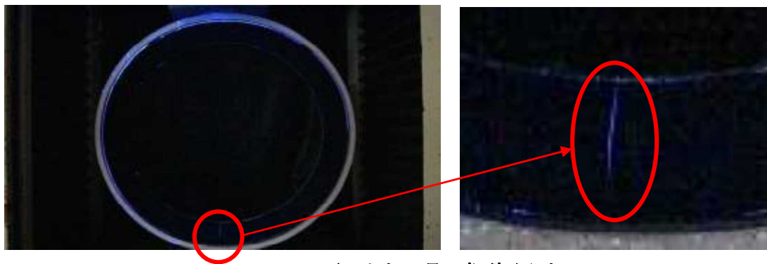
Fig.9 5%のたわみ量で亀裂が発光
