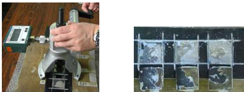
Fig.4 汚れが付着した FRPM 管での付着力試験
