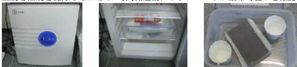
Fig.5 ひび割れ検出上塗り塗料を塗布し 18 時間放置
