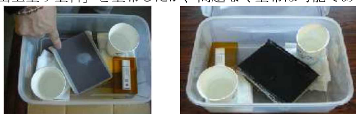
Fig.6 ひび割れ検出上塗り塗料を塗布
