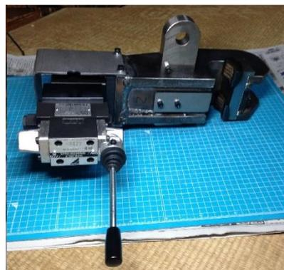
図 16 油圧式鉄筋クランプ
