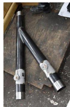
図 12 排土・排水分岐管
