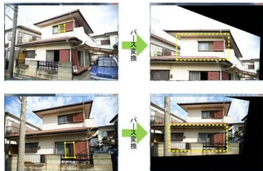
現場写真を正射投影に変換した技術適用の例
