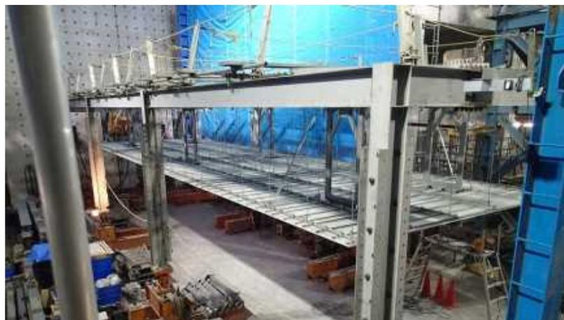
振動実験の様子。耐震要素(水平力抵抗部材)を釣り合いよく配置した試験体は天井面の水平震度3.0相当まで無損傷。
