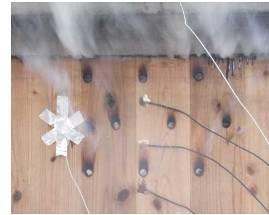
ドリフトピンの燃え抜け
