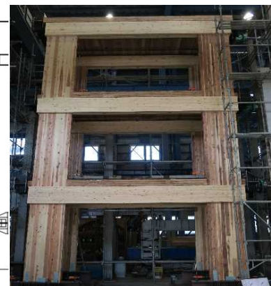
CLT壁 + 集成材梁実大架構 試験体と解析モデル
