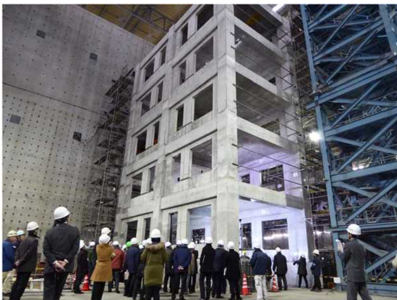
壁を活用した実大5層RC造建築物の載荷実験
