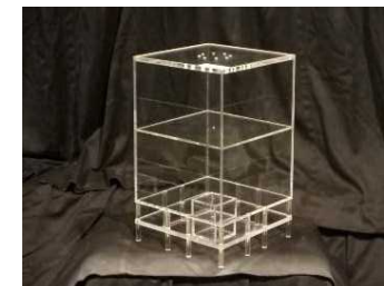
低抗力型建築物の水理模型実験モデルの例
