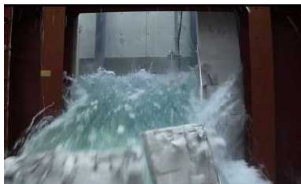
水理実験の状況 (水理実験でのALCパネル脱落の様子)
