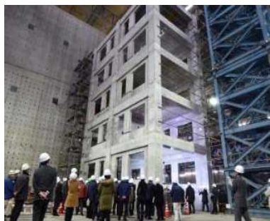
実大5層RC造建築物 載荷実験
