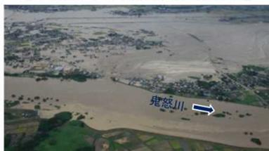
① 鬼怒川の堤防決壊による浸水被害
