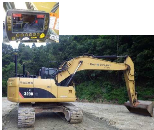
MGスバックホウ (切土・法面整形)
