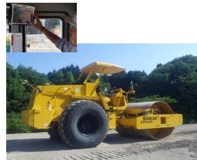
振動ローラー (盛土締固めの面的管理)
