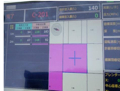
写真6 タブレットによる施工済箇所の確認 (SCM 工法)
