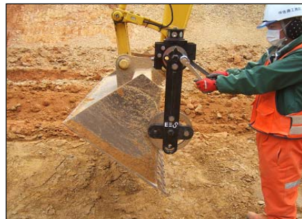
取付け状況 ※3Dマシンガイダンス【E三・S】イーサン・エス NETIS:TH-160014-A
