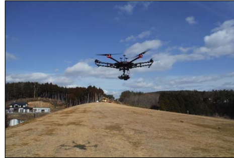
UAVIによる起工測量と出来形計測
