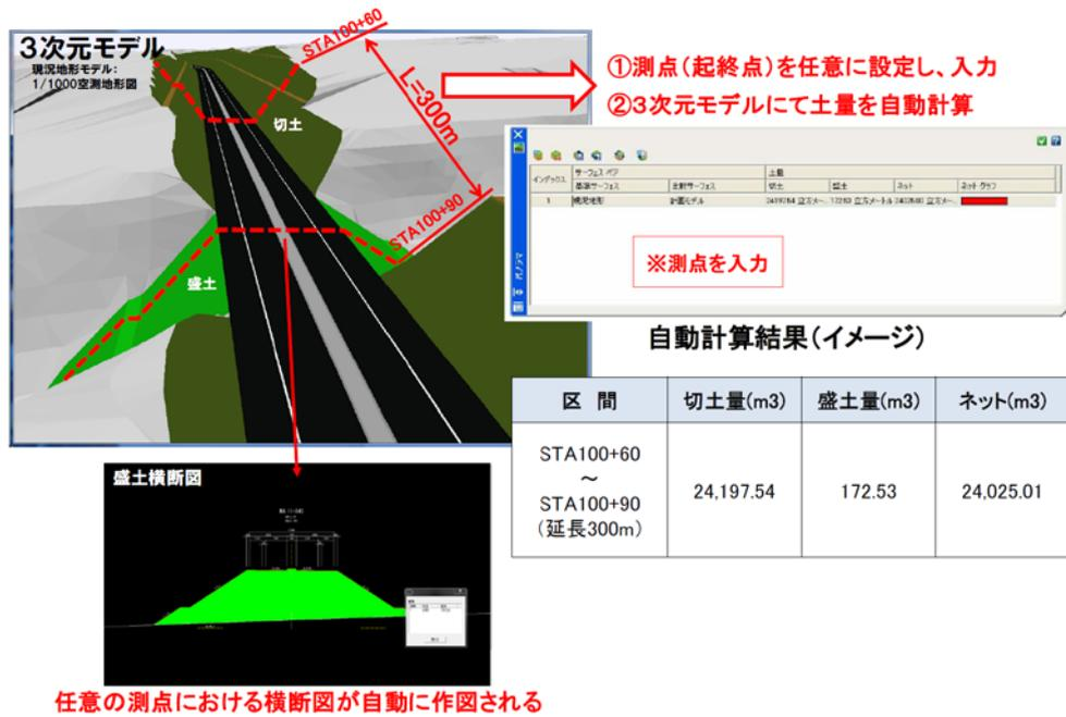
図 9 3次元化による数量自動算出イメージ
