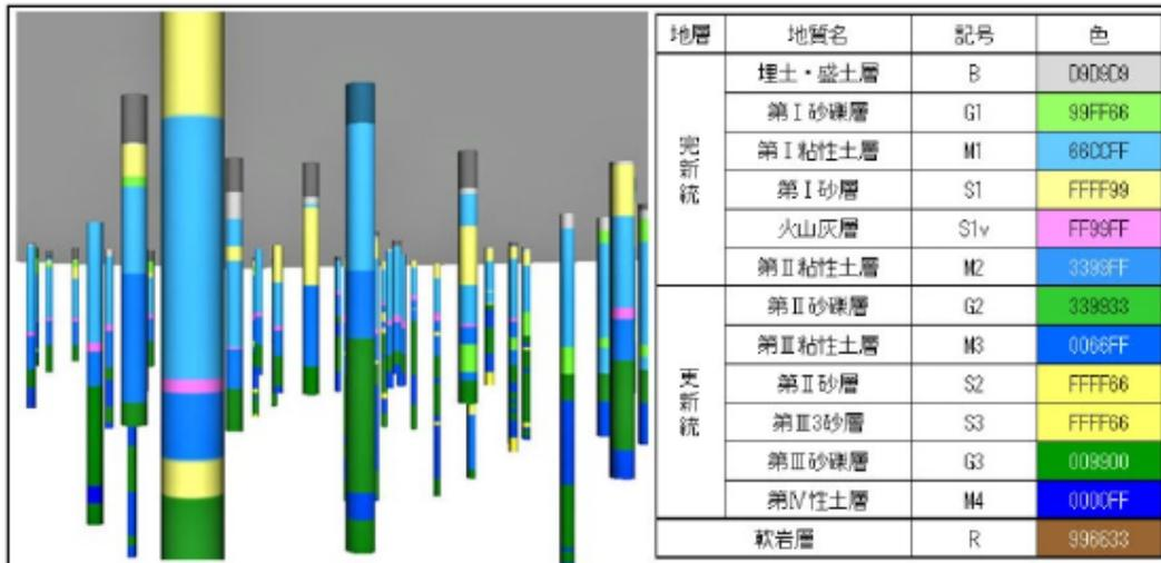
図 62 ボーリングモデルと属性情報のイメージ
