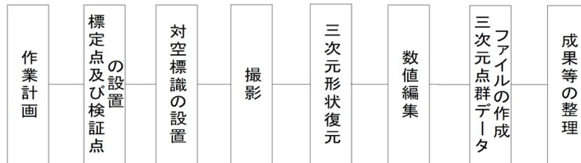
図 37 UAV を用いた空中写真による 3 次元点群測量における工程別作業区分及び順序
