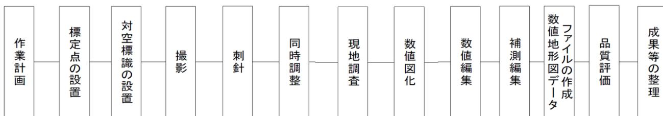
図 36 公共測量作業規程 第 3 編第 3 章空中写真測量における工程別作業区分及び順序
