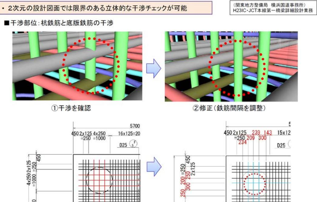
図 18 可視化による干渉確認イメージ
