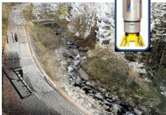
地上レーザ計測による点群データ
