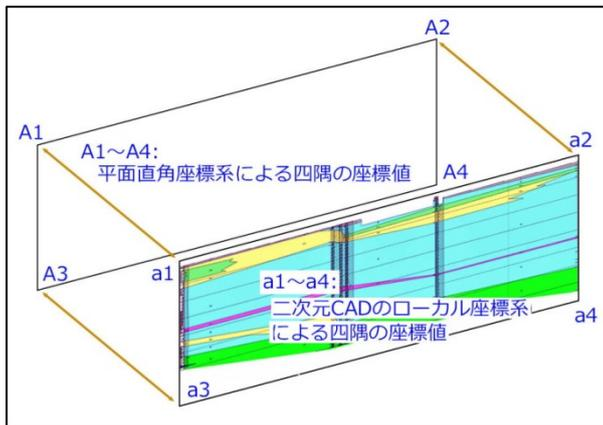
A1~A4：平面直角座標系による断面図の四隅の座標値(断面図の余白を含む)
