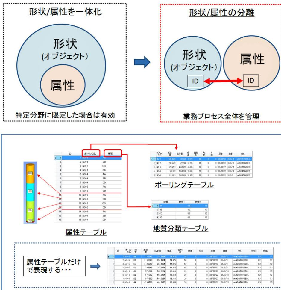
図 61 3次元地盤モデルの属性情報
