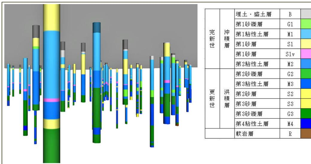
図 67 ボーリングモデルの地質情報に関する属性情報テーブル(完成例)
