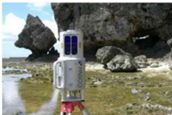
図 47 地上レーザ計測
