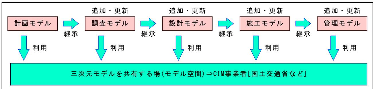
図 59 CIM の各段階と 3 次元地盤モデルデータ
