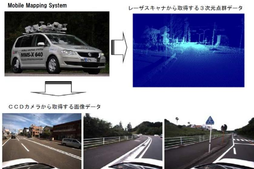
図 40 モービルマッピングシステム (MMS)
