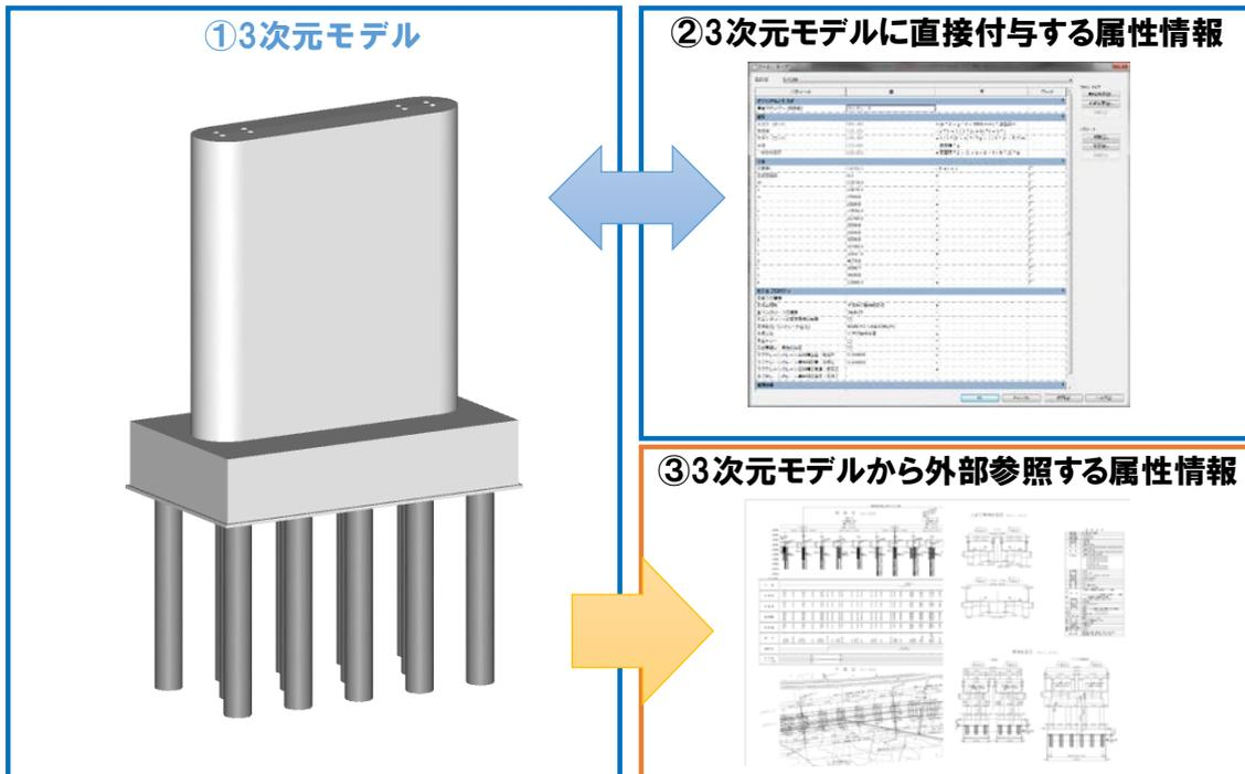
図 24 構造物モデルの例
