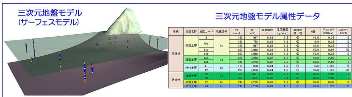
図 60 サーフェスモデルと属性情報の例(イメージ)
