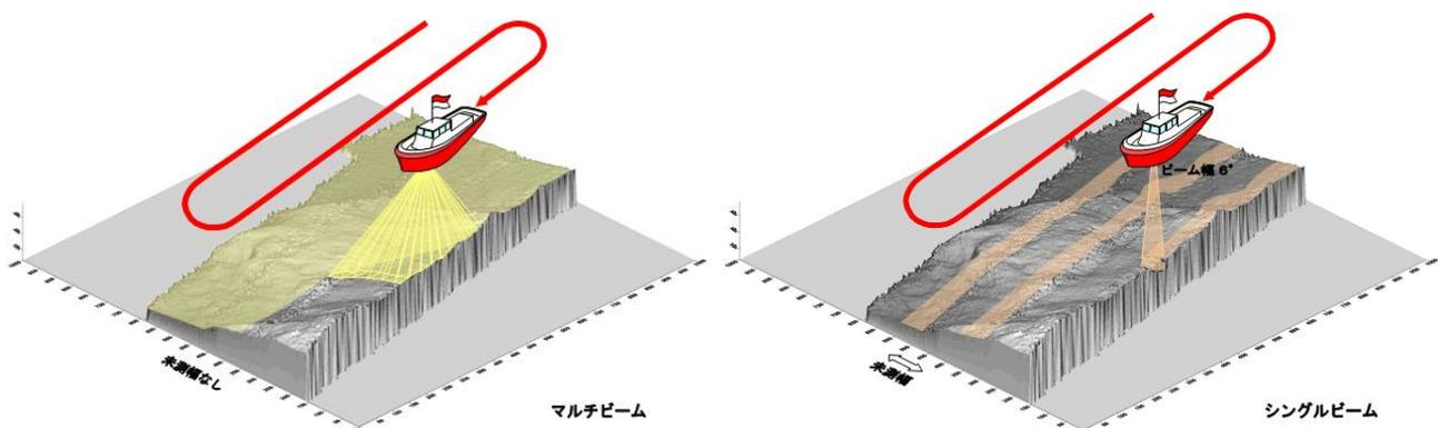
図 53 マルチビーム音響測深とシングルビーム音響測深
