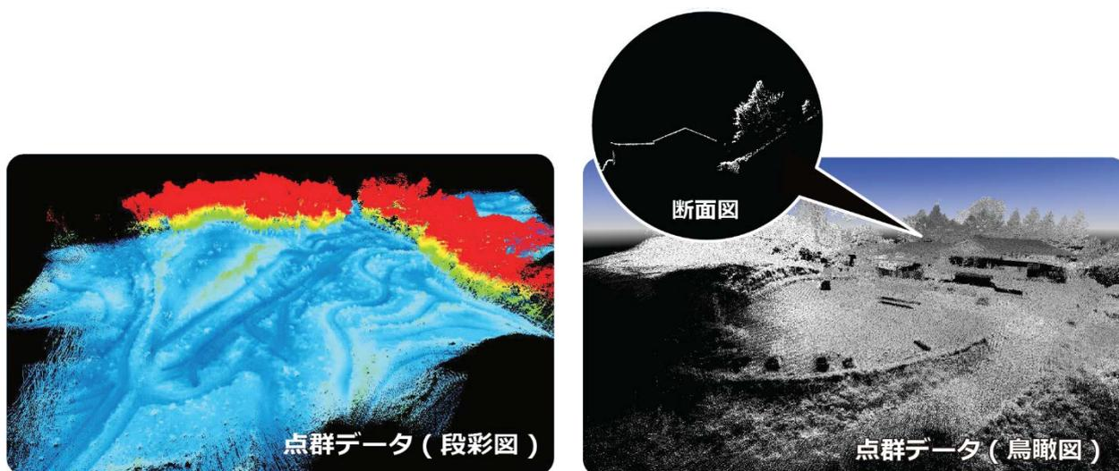
図 51 UAV レーザ測量を利用した点群データの表示イメージ
