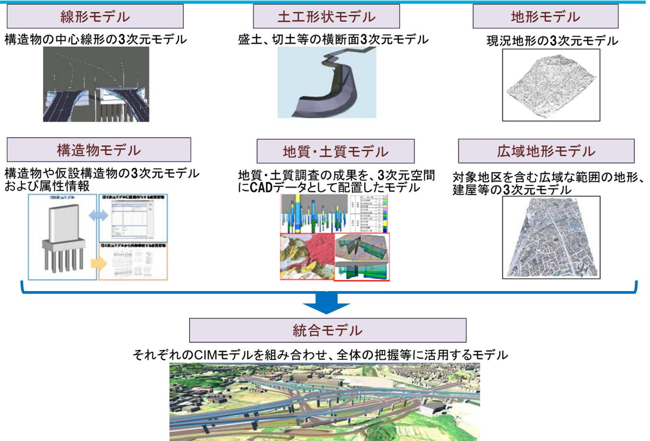
詳細度：CIMモデルの詳細度とは、CIMを活用する目的、場面、段階等に応じた3次元モデルの形状、属性情報に関する作り込みレベル(目安)を示すもの
