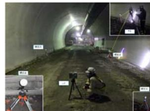
LS計測状況 (覆工コンクリート後)
