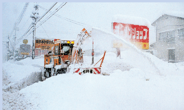
小形除雪車による作業
