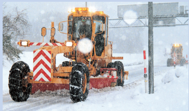
除雪グレーダによる作業
