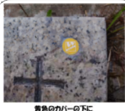
黄色のカバーの下にICタグを付設しています。
