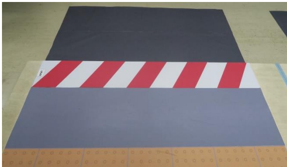
図 6-23 赤／白の中縞（左：全幅 300 mm、右：全幅 600 mm）
