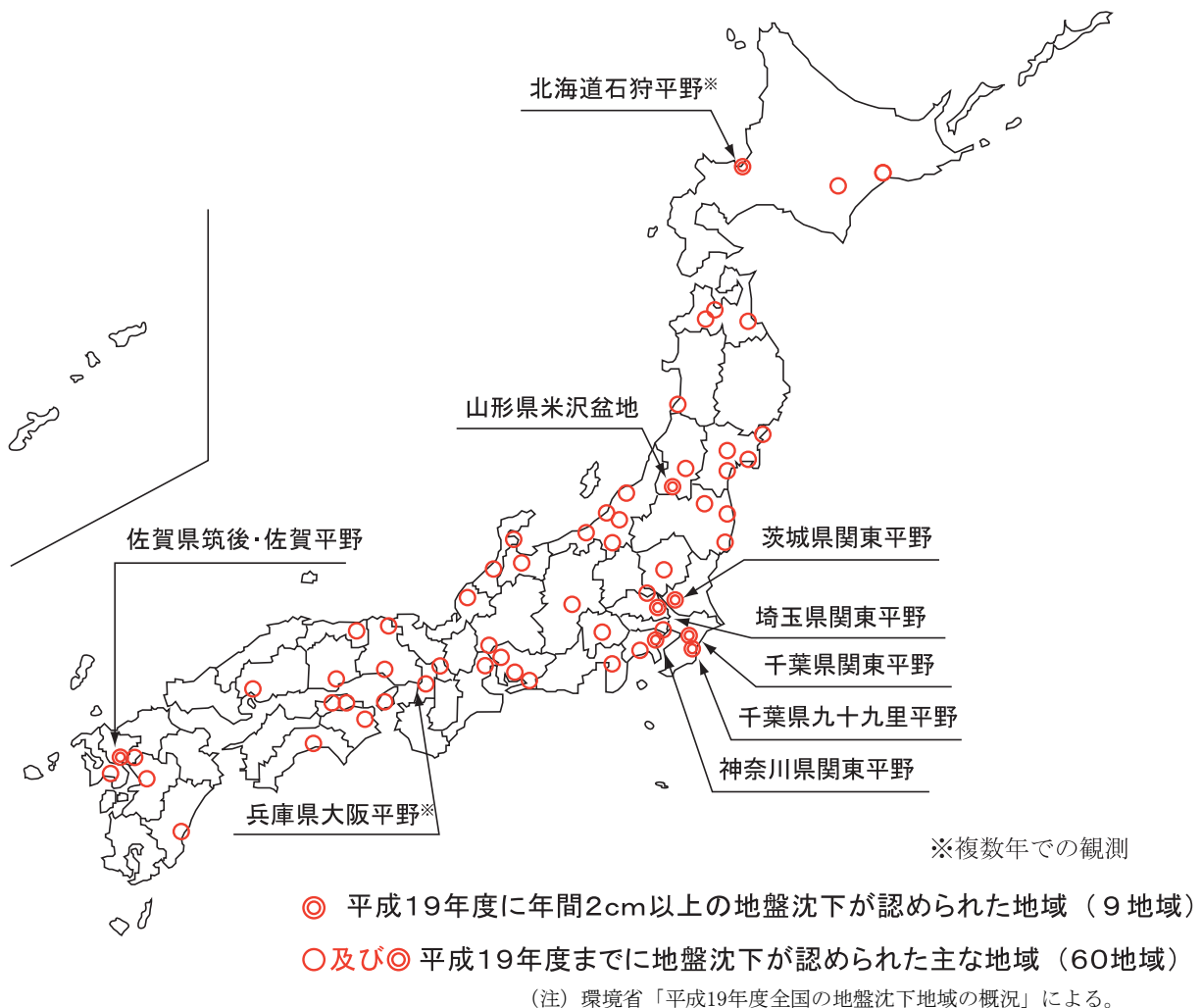
図7-1-2 平成19年度の全国の地盤沈下の状況
