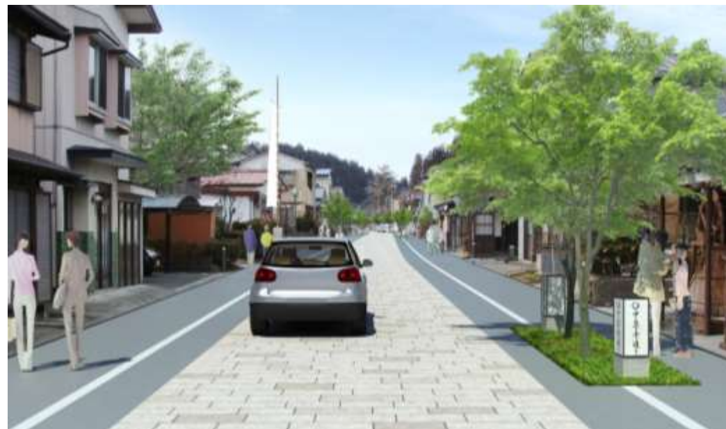
中尊寺通り（平泉町） 車道中央部のみ石張り舗装とすることでイメージ狭さくを喚起
