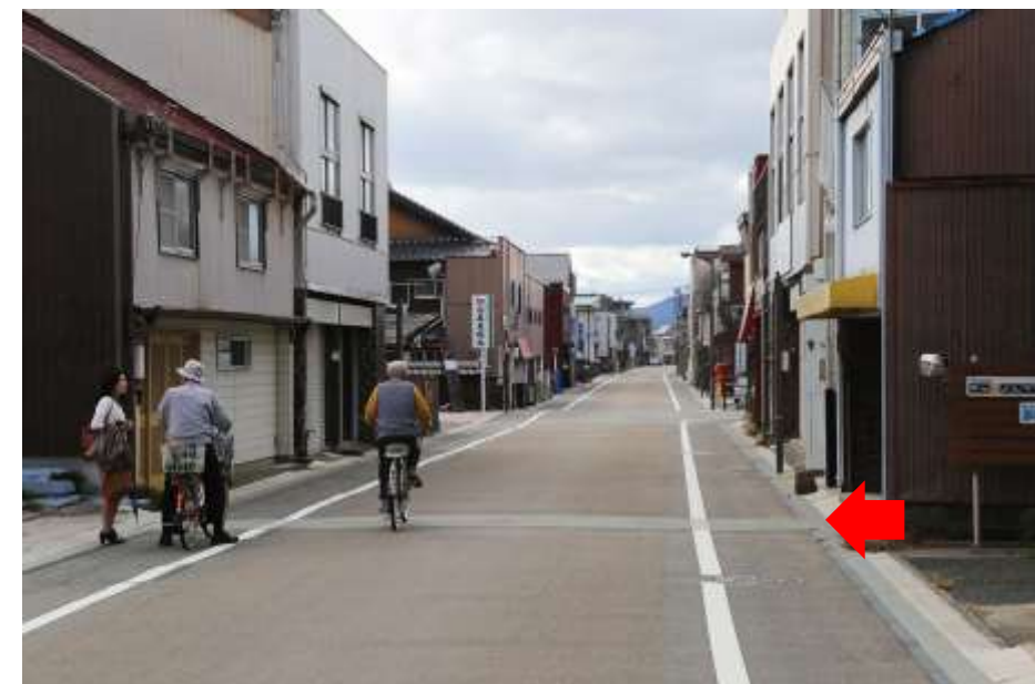
旧山陽道 宮市・国衛地区（防府市） 横断方向の石張り舗装によるイメージハンプの設置
