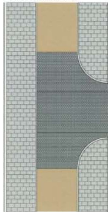
旧東海道品川宿（品川区） 交差点部や人の出入りがある箇所では、他の区間と差別化を図るため 車道部にも石畳舗装を設置
