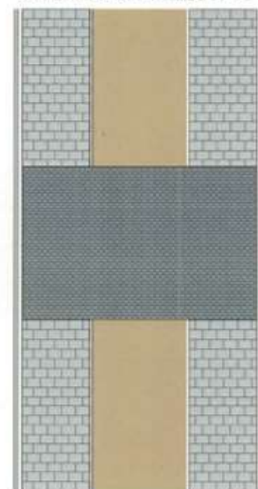
旧東海道品川宿（品川区） 交差点部や人の出入りがある箇所では、他の区間と差別化を図るため 車道部にも石畳舗装を設置
