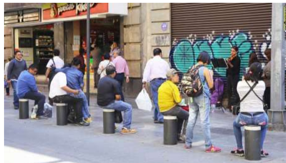
9月16日通り（メキシコ） フラットな歩車道境界に座面としても利用できるボラードを配置している
