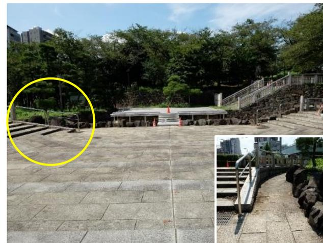
野外ステージの観覧席最前列にアクセスできるスロープを設置し、観覧席最上部と最前列に車椅子使用者が観覧できるスペースを確保。
