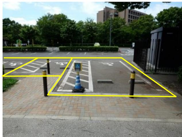
車椅子用リフト付福祉車両（バンタイプでは後部ドアの開閉が通常）の乗降に配慮した有効幅と奥行を確保した駐車区画。
