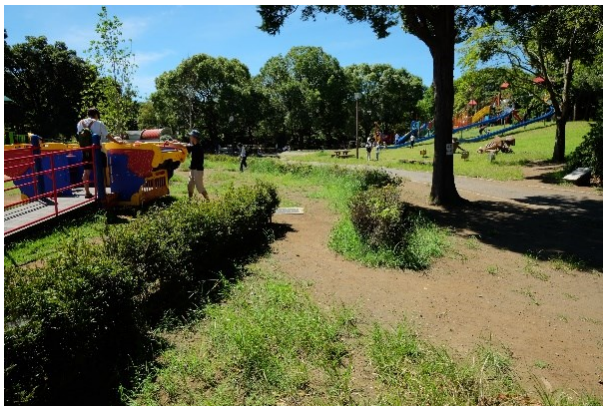
⑤遊び場外周は、当事者団体と議論し、柵ではなく、互い違いにした低木植栽帯を設けて緩やかに囲うことにした
