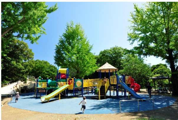
③2代目の複合遊具。車椅子でアプローチ可能な遊具の出入口は2カ所。一番高いデッキまでスロープでアクセスでき、滑り台で滑り降りて遊べる
