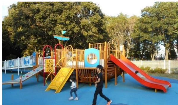
①設置年数が新しく、人気の高い船形の複合遊具は、スロープを取り付ける改修を行い、新たな遊び場のシンボルとして再設置。車椅子でトップデッキに登ることができ、幅広の滑り台は介助者等と一緒に滑り降りて遊べる
