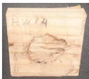
ヒノキ材試験体 試験後/ RIFI
