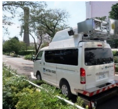
<掲載技術名> 複合探査車 (検出項目: ひび割れ率、わだち掘れ量、IRI)
