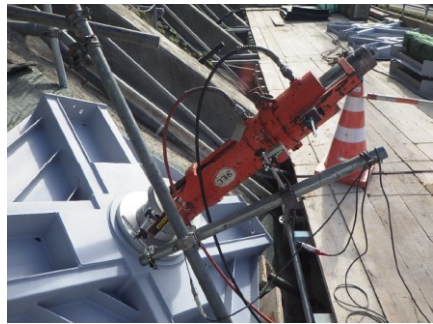
リフトオフ試験*による既設アンカーの残存緊張力の確認
