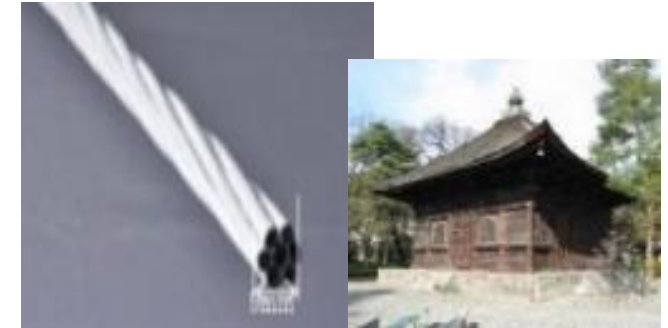
炭素繊維を用いた耐震補強材 (善光寺等の文化財補修に活用)
