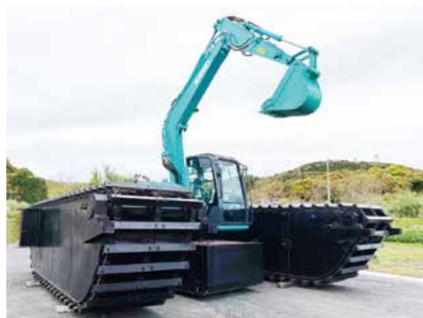
水陸両用掘削機 / Amphibious excavator
