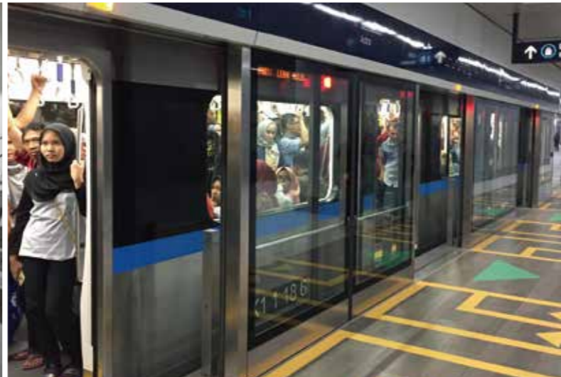
ホームドアと整列乗車ラインが導入されたベンダンガンヒル地下駅構内／ Underground Bendungan Hillr Station with platform screen door and passenger boarding lines
