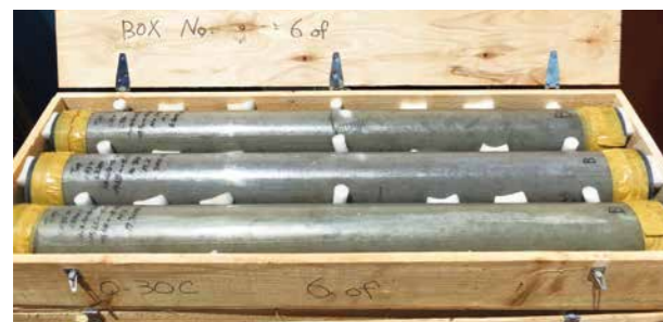
CDM工法による地盤改良後のボーリングコア / Boring core after ground improvement using the CDM method
