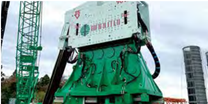
油圧パイプロPVE90VM / Hydraulic Viblo Hammer PVE90VM
