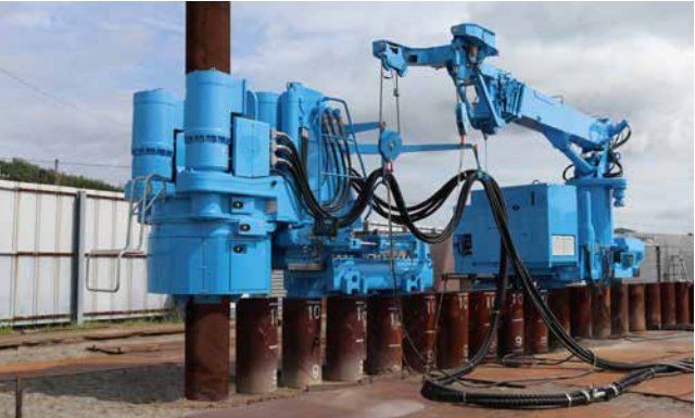
完全電動化により開発された鋼管杭回転切削圧入機(ジャイロパイラー)「GRV0611e」／ Tubular piles rotary cutting press-in machine(GYRO PILER) fully motorized: GRV0611e
