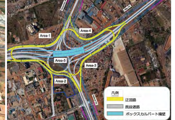
迂回路計画：工事作業帯を確保するため、既存道路の切廻し回数が1回で済む計画を作成・実施／ Detour plan: Create and implement a plan that requires only one detour of the existing road to secure the construction work zone
