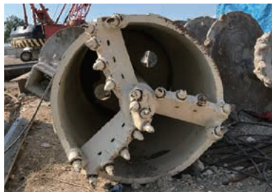
新線橋梁 杭掘削機専用特殊カッティングツール／ Route Neuve Bridge: Special cutting tool for pile excavators
