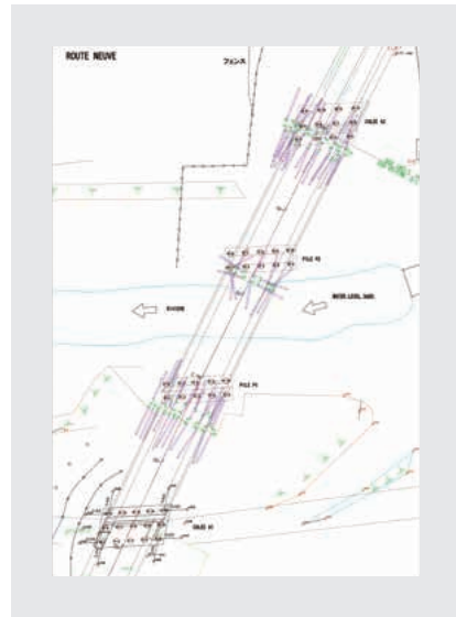
新線橋梁 既設橋梁の斜杭基礎状況 新設する場所打ち杭との干渉範囲のシミュレーション／ Route Neuve Bridge: Condition of existing foundation (inclined piles). Simulation of clashing between new and existing foundation.
