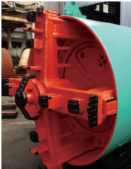
パッケージGで使用した機械式掘進機 推進管の前に設置して地山を掘削
