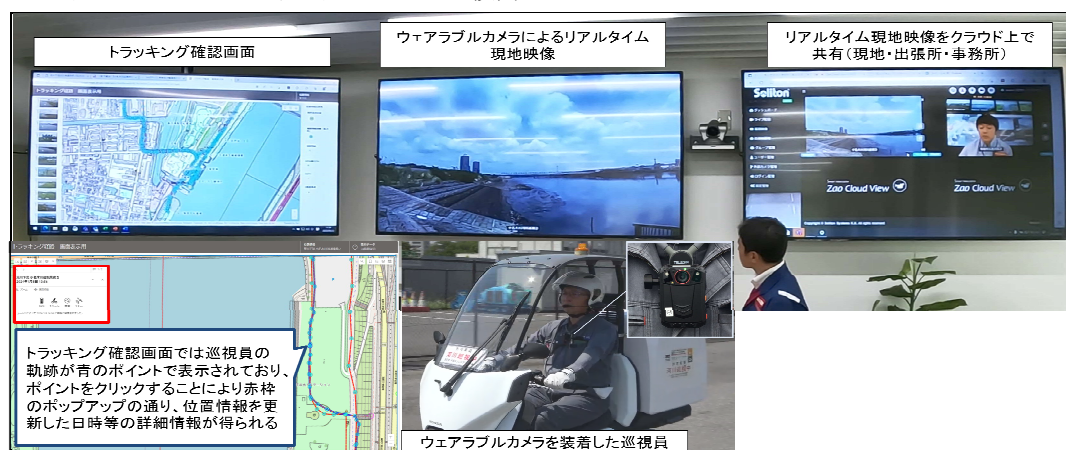
図-1 リアルタイム映像伝送（ウェアラブルカメラ・トラッキング）による河川巡視の様子
