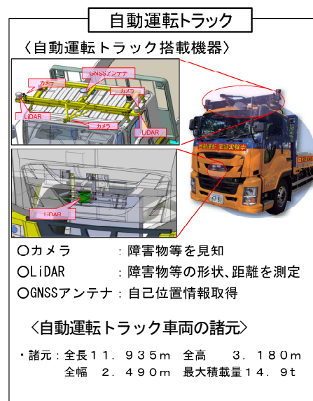
図－3 自動運転トラックの搭載機器
