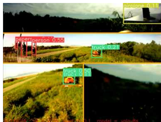
図-6 前方カメラ逆光状況
