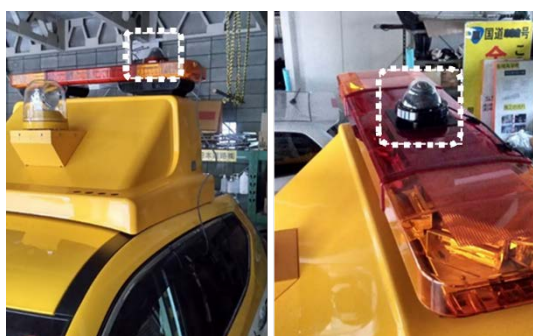
図-9 道路巡回車両に搭載した 360°カメラ機器
