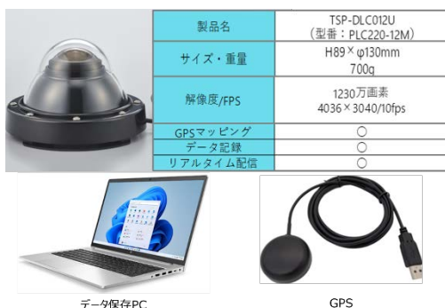
図-8 道路巡回車両に搭載した 360°カメラ機器類
