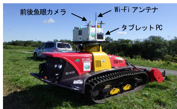
写真-1 堤防草刈機および周囲監視装置設置状況
