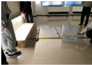
(写真-8 設置高さ50cm)
