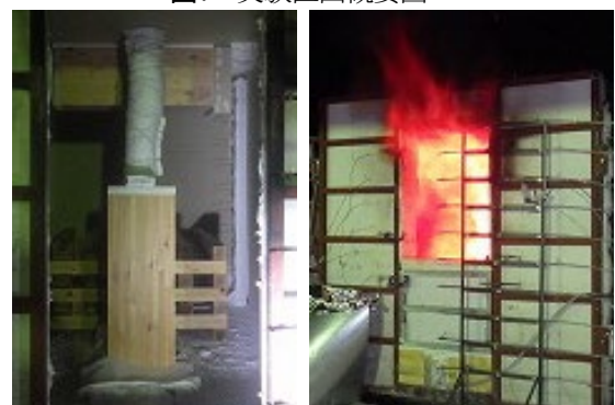
図2 実験前の区画内と実験中の状況
