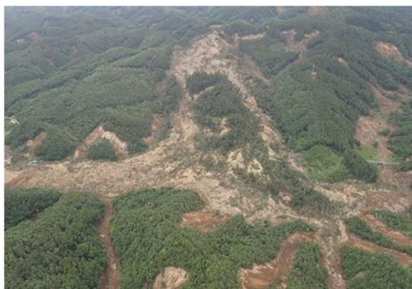
図-1 大量の流出土砂による河道埋塞
