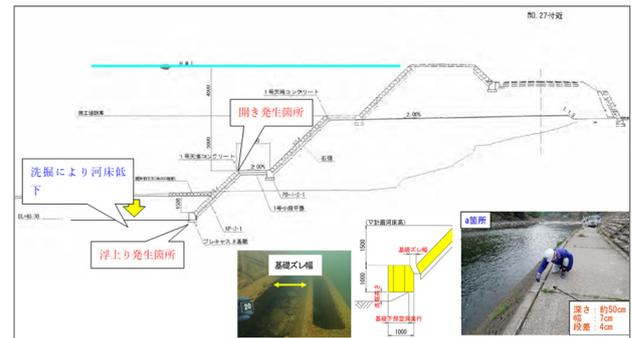
図-4 太田川中流域における護岸基礎の被災状況
