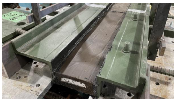
図-12 伸縮追従性能確認試験（止水機能部二次製品）
