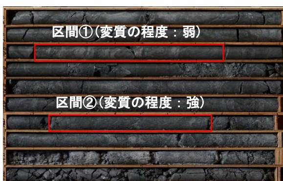
写真-10 安山岩溶岩 (熱水変質) コア
