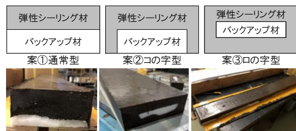
図-14 止水機能部の二次製品化検討案
