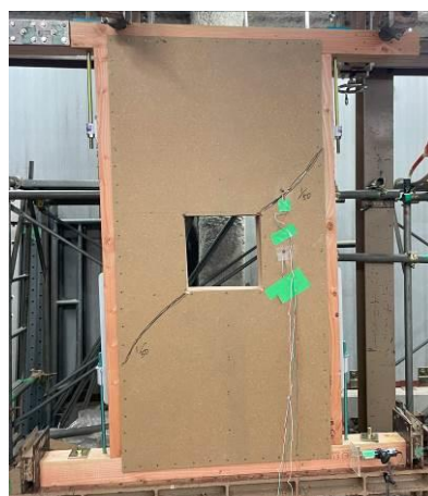
図4 b9_50@75_322MM_mdf の終局状態
