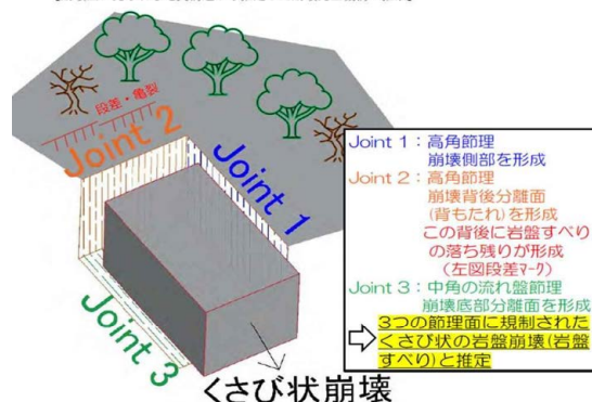
図-5 崩壊のメカニズム (模式図)
