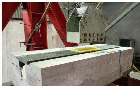
図-8 繰り返し载荷試験実施状況
