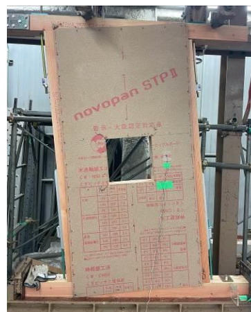
図5 b9_50@150_322MM_pb の終局状態
