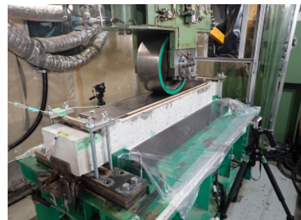
写真-2 小型輪荷重走行試験機
