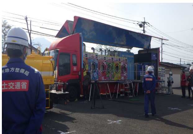
写真-8 災害時用WASHハウス移動式ランドリー車
