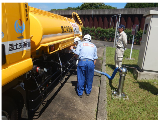
写真一1 散水車への給水
