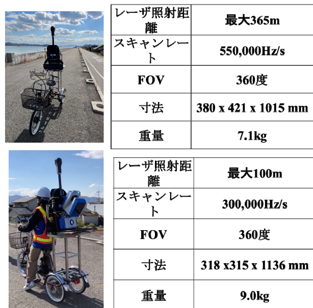
図-3 本試行にて使用した LidarSLAM の概観と仕様 上図：GNSS の搭載なし 下図：GNSS の搭載あり
