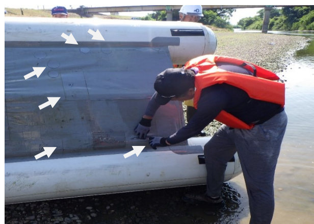
図-8 船底の多数の損傷（船内に浸水も）
