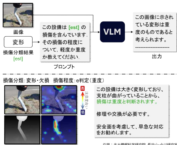
図-7 VLMを活用した損傷の程度推定、変形・欠損e判定事例
