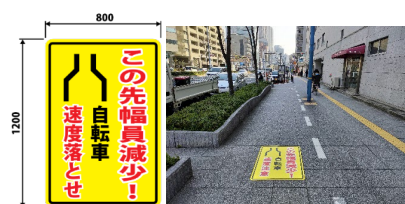
図 19 ④浄正橋西 ST 付近の注意喚起シール
