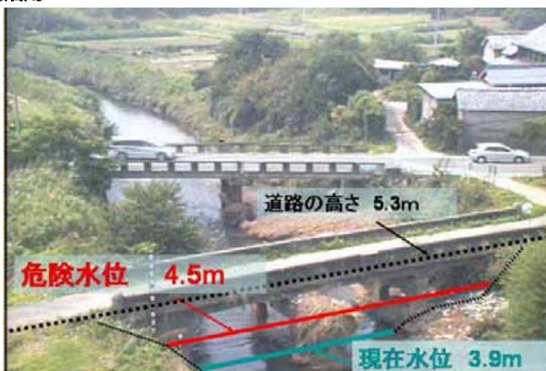
図 - 4 . 5 映像にC G 技術を組合せた水位表示の例イメージ
