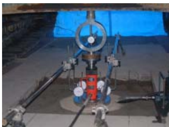
写真 - 2 平板載荷試験実施状況
