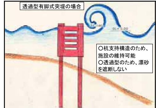
【図-3】透過型有脚式突堤イメージ
