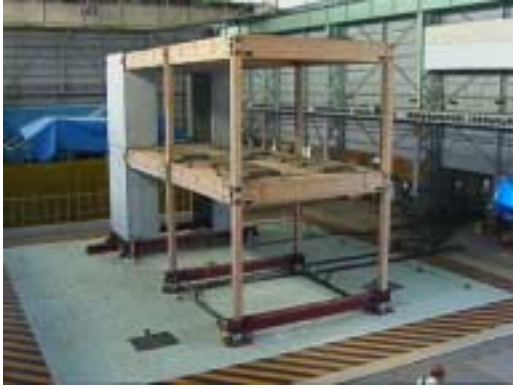
図 - 7 複合システムの実大振動実験（左：2層の試験体、右：接合部の破壊状態）
