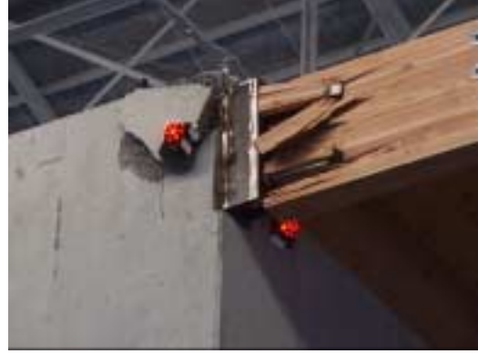
図 - 7 複合システムの実大振動実験（左：2層の試験体、右：接合部の破壊状態）
