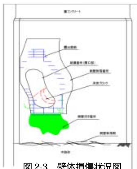
図2-3 壁体損傷状況図
