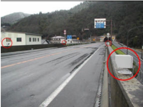
写真-1 簡易交通量計測装置設置状況
