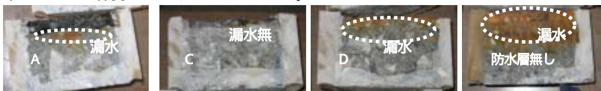
写真6 防水性試験漏水状況
