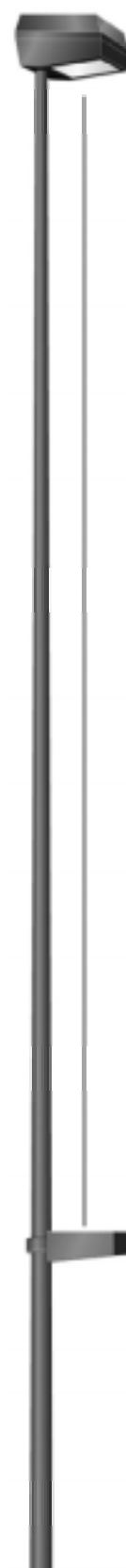
図 4 昇降式照明灯装置
