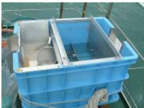
写真 - 3 油水粗分離器
