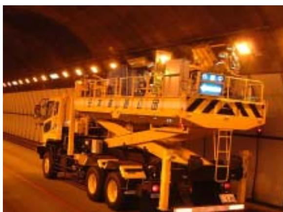
写真 - 1（トンネル照明灯具洗淨装置全景）
